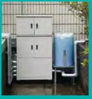
必要な装備を最小スペースに設置。施肥は、 原液タンクから、濃度調整したうえで点滴 ドリップチューブから植物に与えられます。
